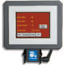
便于操作的AutoTouch™ 控制屏使操作工容易进行任务的设置、调用和诊断
