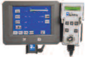
AutoTouch触摸屏 快速方便地储存和调用任务参数、执行系统诊断和显示生产率数据
